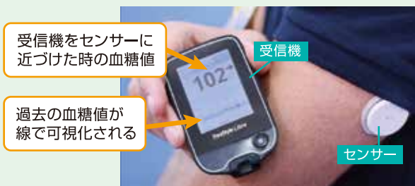
図2 iCGM器による血糖測定
